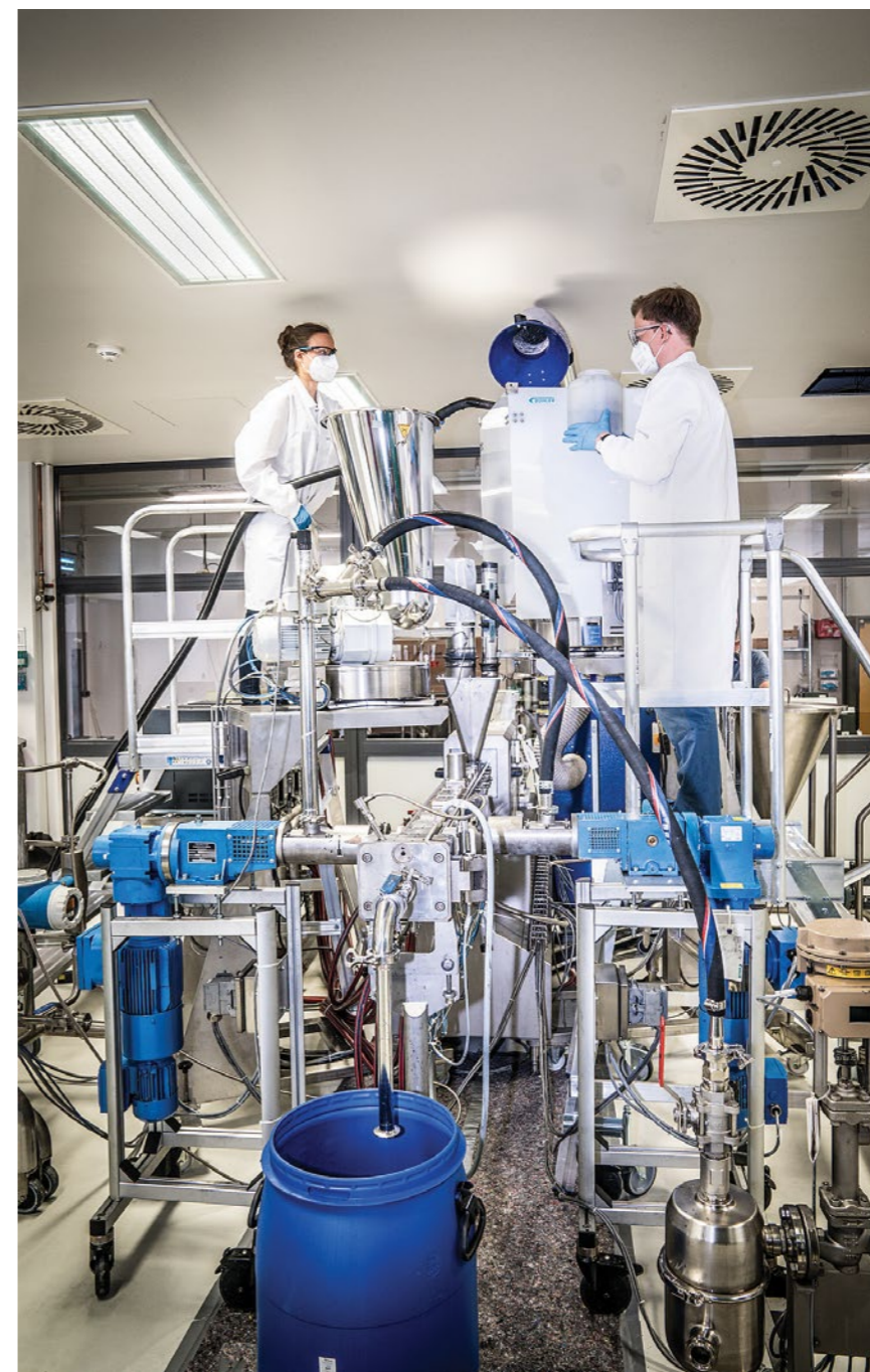
Bild 6 > Praktische Arbeiten am Extruder. Beim Mischvorgang werden mindestens zwei getrennte Ausgangsstoffe zu einer Elektrodenpaste (Slurry) gemischt. Den Aktivmaterialien werden auch Leitadditive sowie Lösungs- und Bindemittel beigefügt (© Fraunhofer FFB)
