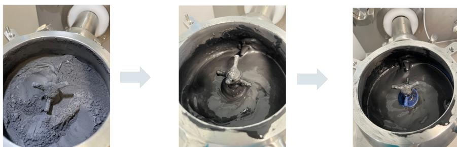
Fig.3 Prozessverlauf an dem DIOSNA Batch Mischer High-shear Granulierer Typ P1-6
