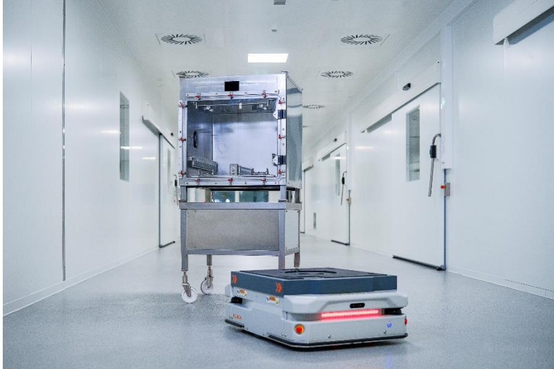
Abb. 1 Auf der Hannover Messe stellt die FFB-Ausgründung »Syvairo« die Mini-Environment-Transportbox vor. Als mobiler Rein- und Trockenraum ermöglicht sie den klimastabilen Materialtransport empfindlicher Materialien. © Fraunhofer FFB
